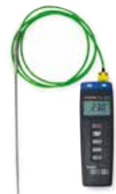
Miernik temperatury do RAKU 100, łatwy w obsłudze, czujnik temperatury NiCr-Ni, wskazanie w zakresie 20 °C - 1200 °C, możliwość podłączenia drugiego czujnika z przetwarzaniem wskazania
